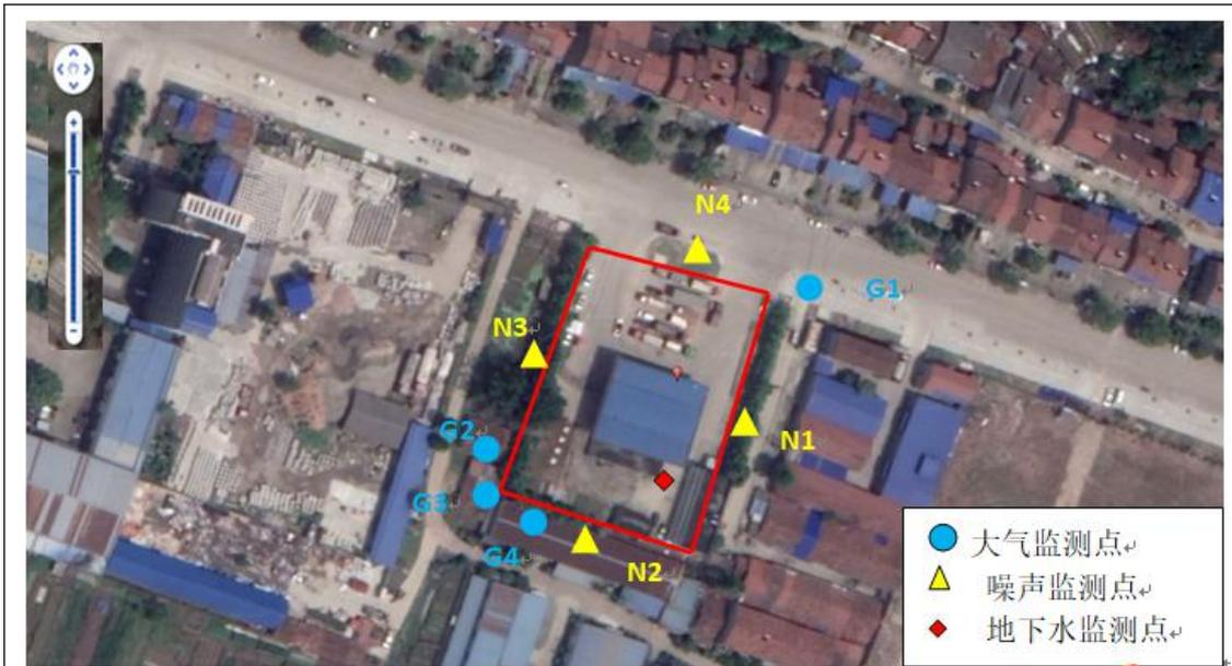
图 6-1 废气、噪声、地下水监测布点示意图
